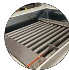
Intercambiador de calor
