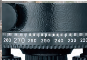
Círculo horizontal com acionamento lateral de precisão infinito para visar com exatidão.
